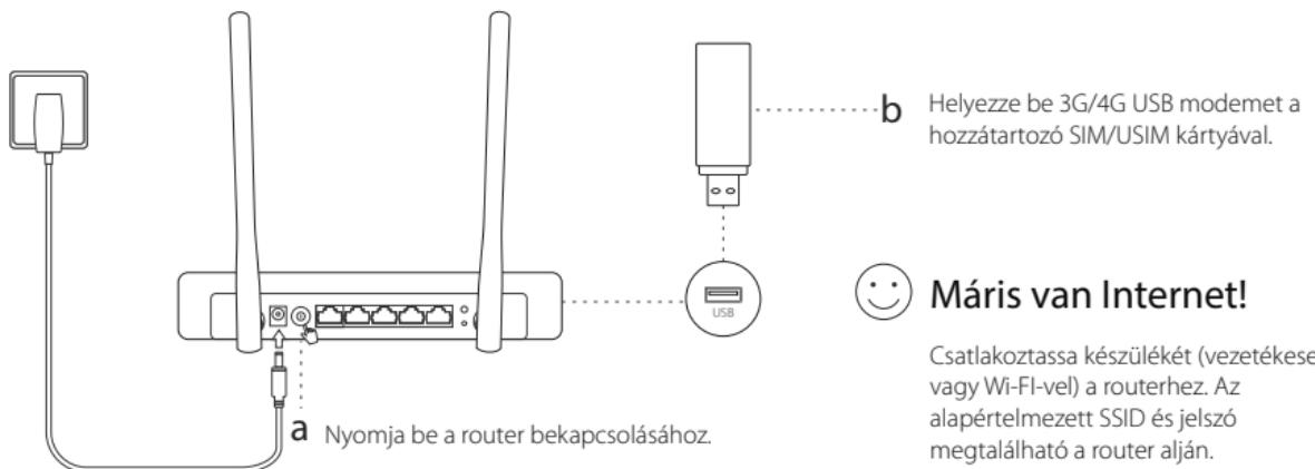
Csatlakoztassa készülékét (vezetékesen vagy Wi-Fi-vel) a routerhez. Az alapértelmezett SSID és jelszó megtalálható a router alján.
