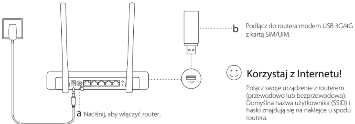
b Podłącz do routera modem USB 3G/4G z kartą SIM/UIM.
