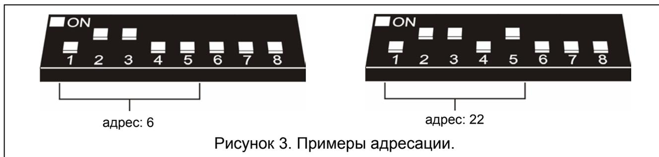
Пять переключателей позволяет присваивать адреса 32 расширителям (числа от 0 до 31). Адреса расширителей подключенных к одной шине не могут повторяться, зато порядок адресации произволен. Рекомендуется присваивать подключаемым к одной шине расширителям и модулям очередные адреса, начиная с нуля. Это позволит избежать проблем при расширении системы.
