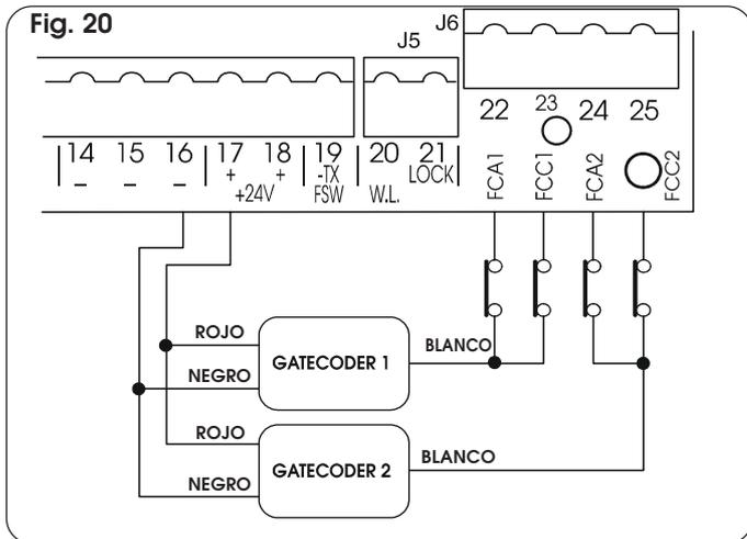
**NOTA:** Las configuraciones indicadas en los dibujos son las máximas. Se permiten todas las configuraciones intermedias, utilizando sólo algunos elementos (sólo 1 fin de Gatecoder, sólo 1 fin de carrera, 2 Gatecoder y 2 fines de carrera, etc.). En este caso hay que puentear a masa las entradas que no se utilicen.
