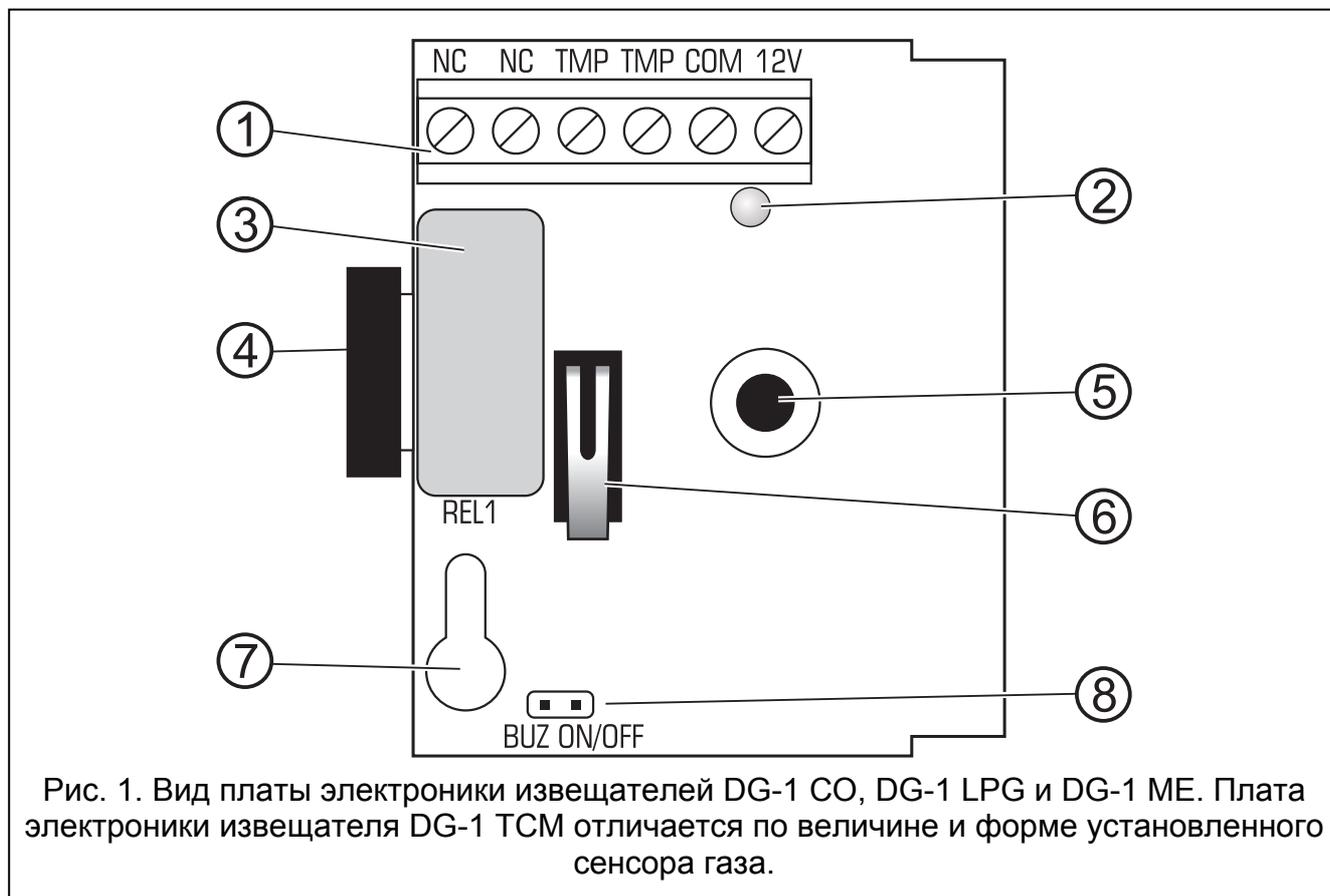
Рис. 1. Вид платы электроники извещателей DG-1 CO, DG-1 LPG и DG-1 ME. Плата электроники извещателя DG-1 TCM отличается по величине и форме установленного сенсора газа.
