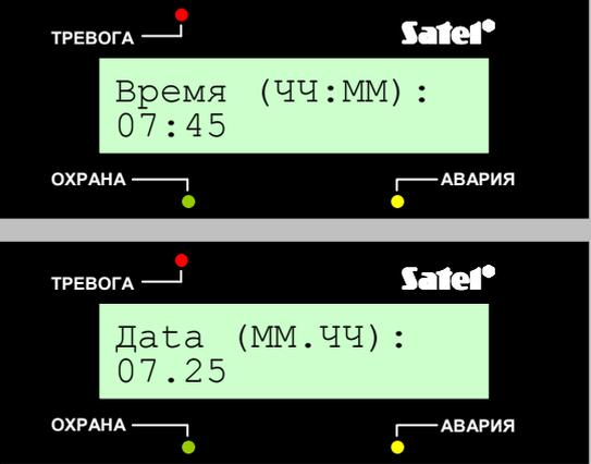
ЖКИ-клавиатура высвечивает время, зато в клавиатуре LED имеется возможность **проверки времени и даты** в установках ПКП. Для этой цели необходимо произвести вызов функции 6 пользователя и двойным нажатием клавиши [\*] проверить цифры, высвечивающиеся светодиодами (от 2 до 5) в последовательности программирования. Первая цифра высвечивается сразу же после вызова функции.
