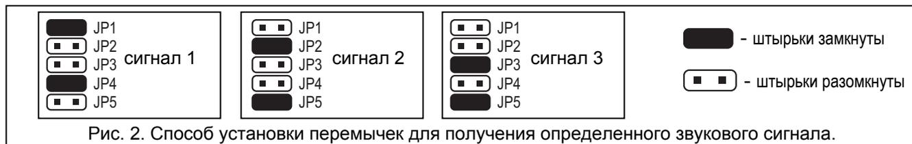
С помощью перемычек, устанавливаемых на штырьки **JP1 – JP5**, выбирается одна из трех тональностей тревожного сигнала.
