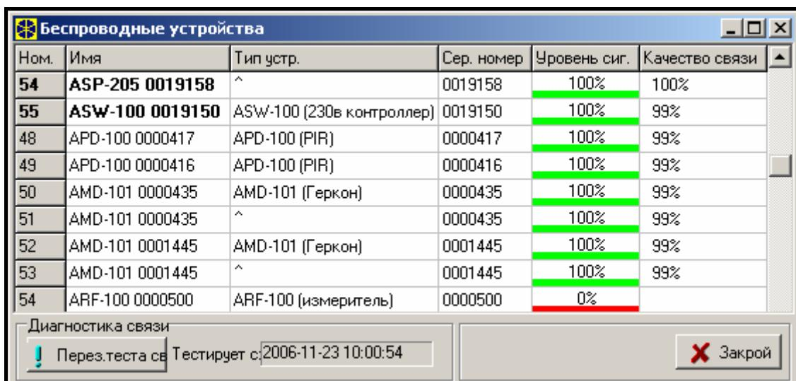
Рис. 16. Окно программы DLOADX с указанием уровня сигнала и качества связи контроллера с беспроводными устройствами.
