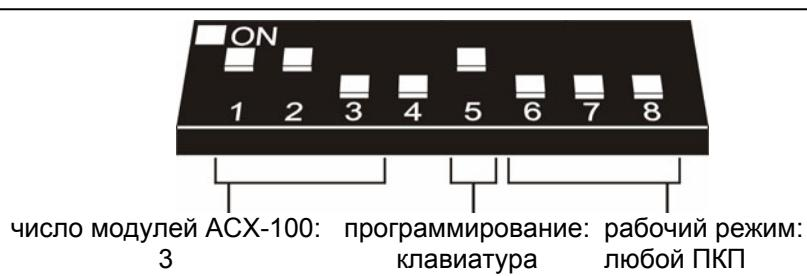
Рис. 13. Пример установки DIP-переключателей.
