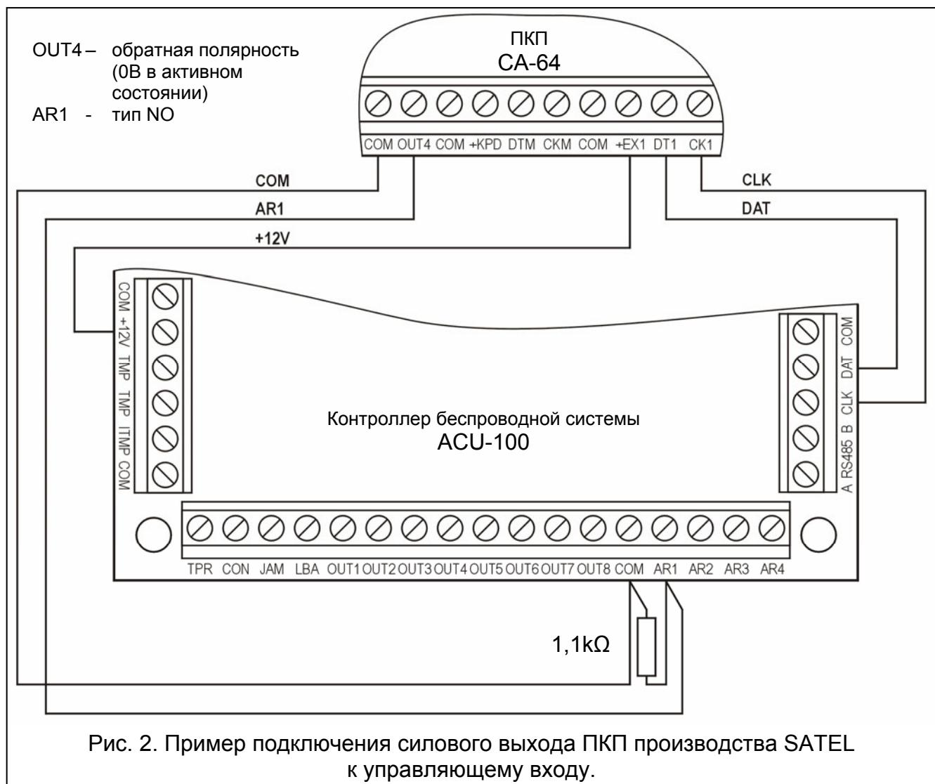
Выходы ПКП, используемые для управления входами контроллера ACU-100 должны быть настроены соответствующим образом (тип, поляризация, время действия и пр.).
