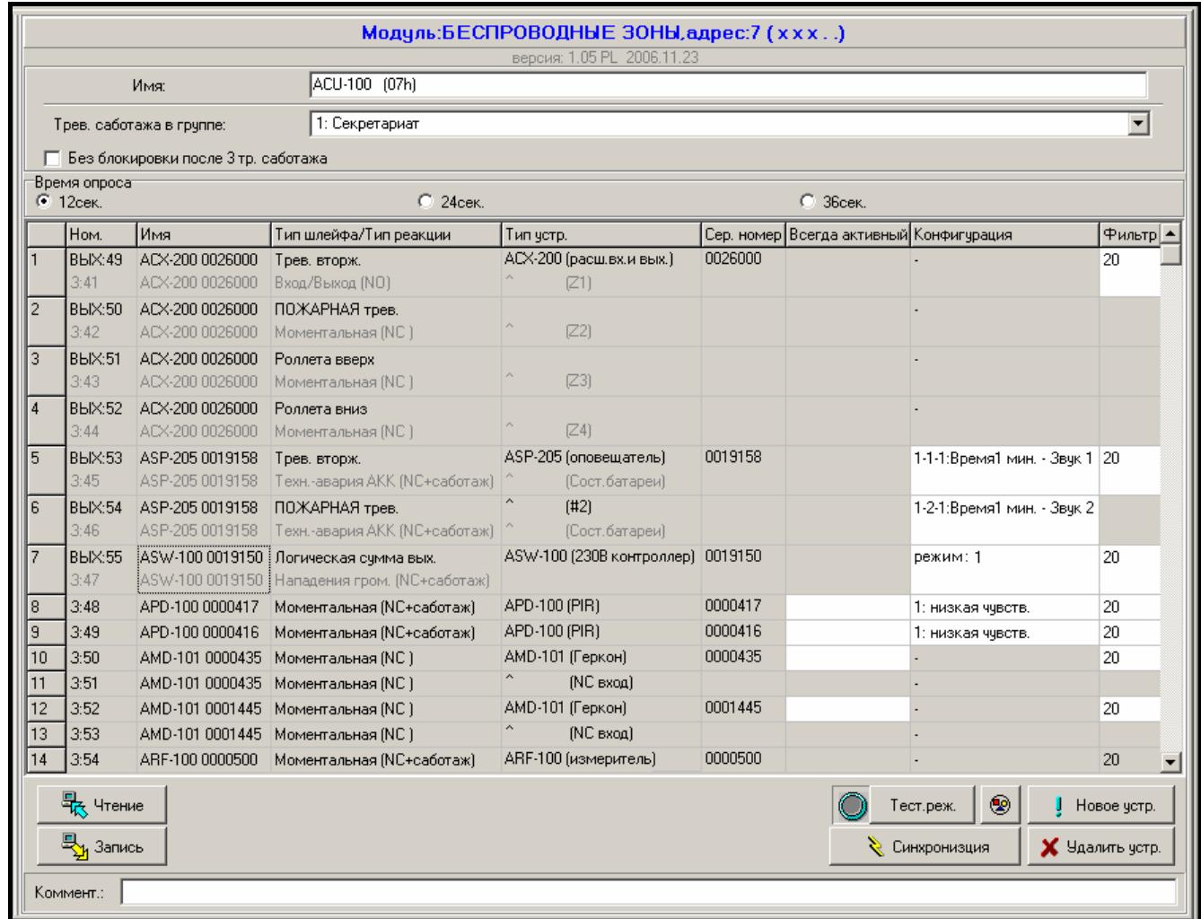
Рис. 15. Конфигурация ACU-100 в программе DLOADX. Ниже информации о типе модуля и его адресе находится информация о версии микропрограммы. Беспроводные устройства были зарегистрированы в контроллере согласно описанию, приведенному выше в настоящем руководстве: в первую очередь были добавлены устройства, которые занимают в системе зоны и выходы, а только потом устройства, занимающие одни зоны. Измеритель уровня радиосигнала был добавлен, как последний.
