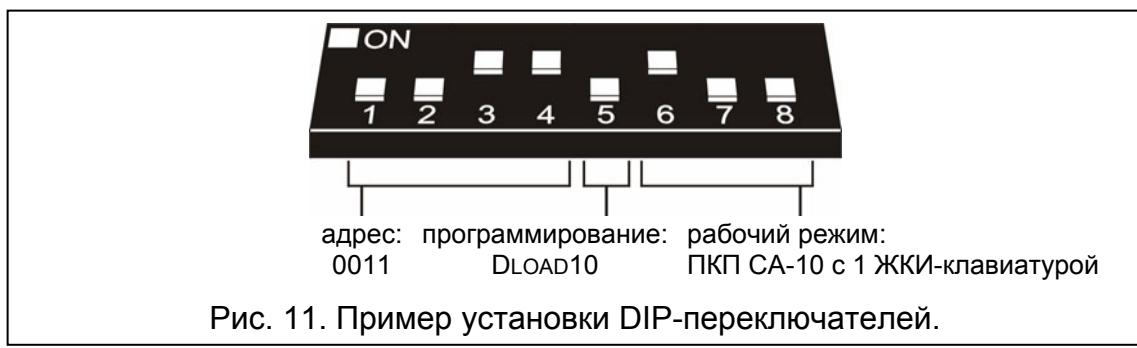
Рис. 11. Пример установки DIP-переключателей.
