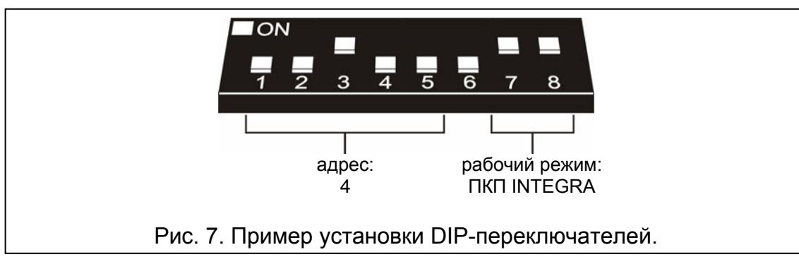
Рис. 7. Пример установки DIP-переключателей.
