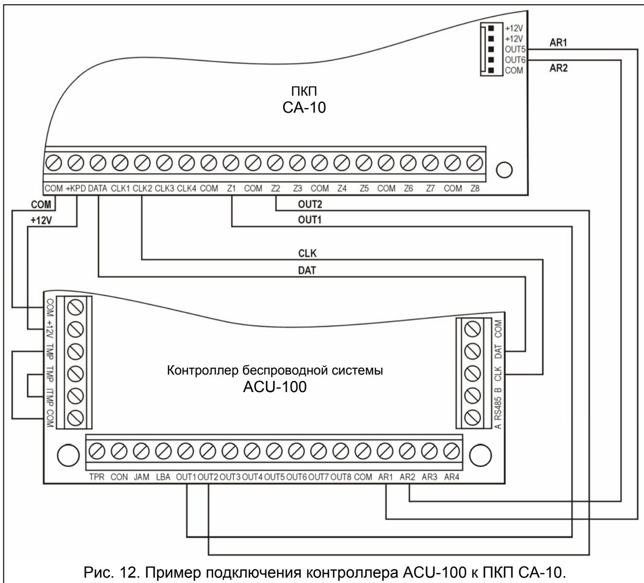
Рис. 12. Пример подключения контроллера ACU-100 к ПКП CA-10.
