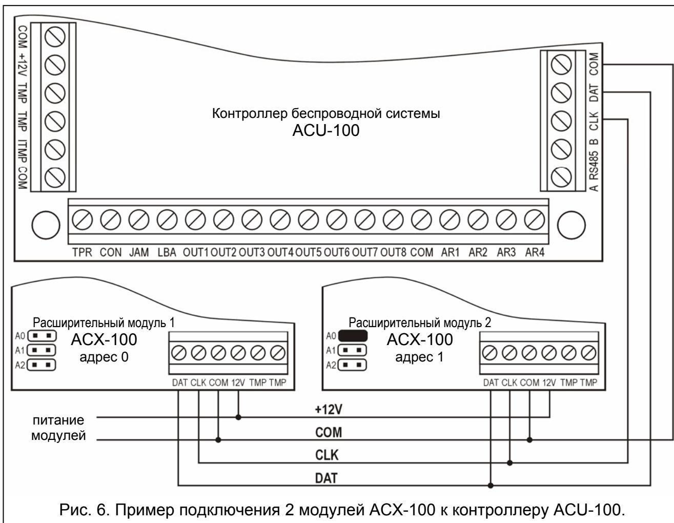
Клеммы модуля TMP должны быть подключены к тамперной зоне ПКП.
