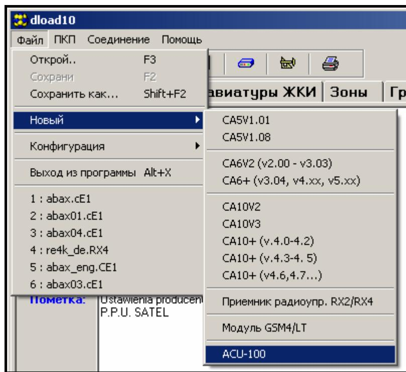
Рис. 17. Выбор обслуживания контроллера ACU-100 в программе DLOAD10.
