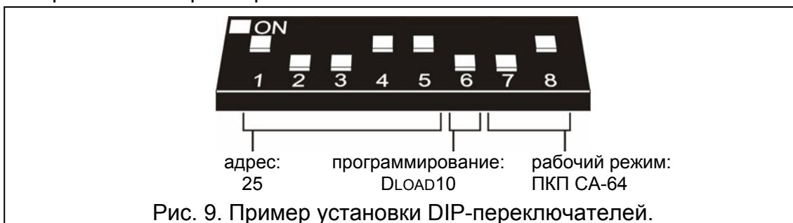
Рис. 9. Пример установки DIP-переключателей.
