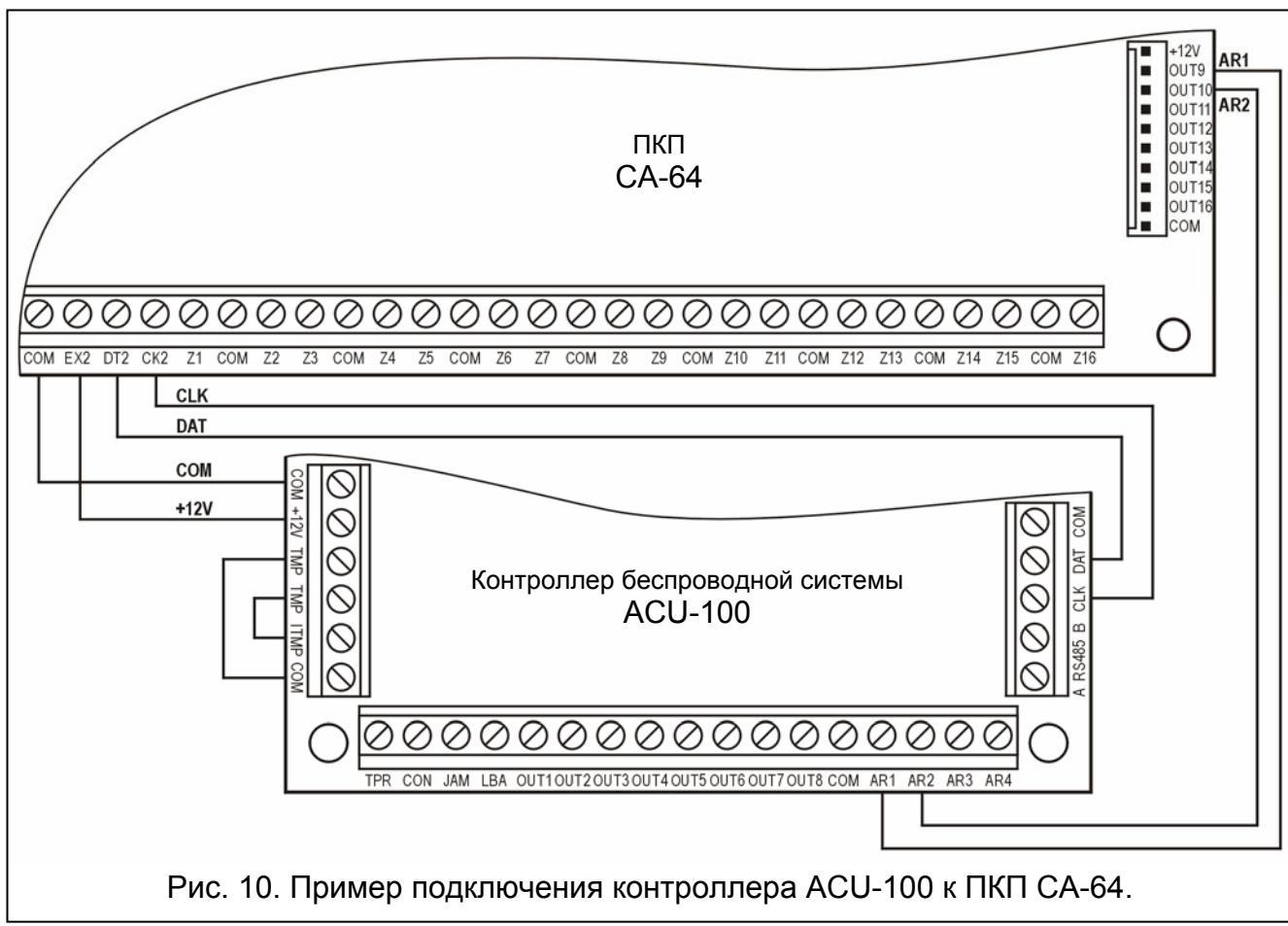
Рис. 10. Пример подключения контроллера ACU-100 к ПКП СА-64.
