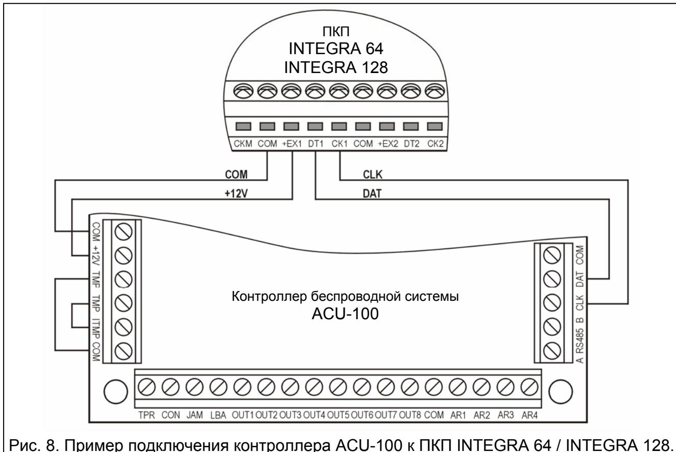
Рис. 8. Пример подключения контроллера ACU-100 к ПКП INTEGRA 64 / INTEGRA 128.
