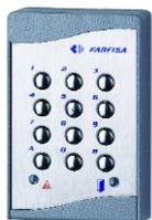
Clavier avec platine (IP45) contre les effractions à montage superficiel pour le contrôle des accès et boutons poussoirs, tout en acier inox. Deux relais pour l'ouverture de la gâche, le contrôle des accès, etc. Le clavier est utilisé pour la programmation et la composition des codes d'activation des relais. Mise hors service du clavier avec temps progressif (max. 25 sec.) si la combinaison est incorrecte. Codes programmables de 1 à 8 chiffres
