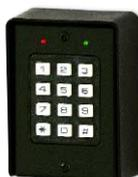
Clavier pour le contrôle des accès avec platine, boutons poussoirs et boîtier en plastique. Un relais pour l'ouverture de la gâche, le contrôle des accès, etc. Le clavier est utilisé pour la programmation et la composition des codes d'activation des relais. Mise hors service du clavier avec temps progressif (max. 25 sec.) si la combinaison est incorrecte. 8 codes programmables de 2 à 6 chiffres
