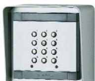
Clavier avec platine en aluminium et boutons poussoirs en acier inox, à utiliser avec les plaques de rue de la série Mody. Deux relais pour l'ouverture de la gâche, le contrôle des accès, etc. Le clavier est utilisé pour la programmation et la composition des codes d'activation des relais. Mise hors service du clavier avec temps progressif (max. 25 sec.) si la combinaison est incorrecte. 4 codes programmables de 2 à 6 chiffres pour
