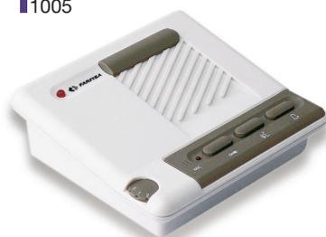
Interphone à courant porteur fonctionnant à mains libres avec commutation phonique automatique ou manuelle. Permet d'effectuer simultanément un maximum de 3 conversations indépendantes. Equipé de réglage du volume, interrupteur de mise sous tension, bouton d'appel et sélecteur de canal (A-BC). Il suffit de le brancher à la prise secteur. Aucune installation n'est nécessaire. Entrée 230V.
