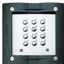
Clavier "Stand Alone" anti-vandale (IP45, avec platine et boutons poussoirs en acier inox) qui peut soit être installé individuellement, soit en composition avec la série Matrix traditionnelle ou digitale audio ou vidéo. 2 relais pour ouverture de porte avec 12 codes programmables de 1 à 8 chiffres pour chaque relais. Possibilité d'activation des relais avec bouton additionnel (exit button). Relais
