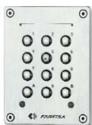
Clavier avec platine contre les effractions pour le contrôle des accès et boutons poussoirs, tout en acier inox. Deux relais pour l'ouverture de la gâche, le contrôle des accès, etc. Le clavier est utilisé pour la programmation et la composition des codes d'activation des relais. Mise hors service du clavier avec temps progressif (max. 25 sec.) si la combinaison est incorrecte. 4 codes programmables de 2 à 6 chiffres pour chaque relais. Possibilité d'activer le relais 2 en ap-
