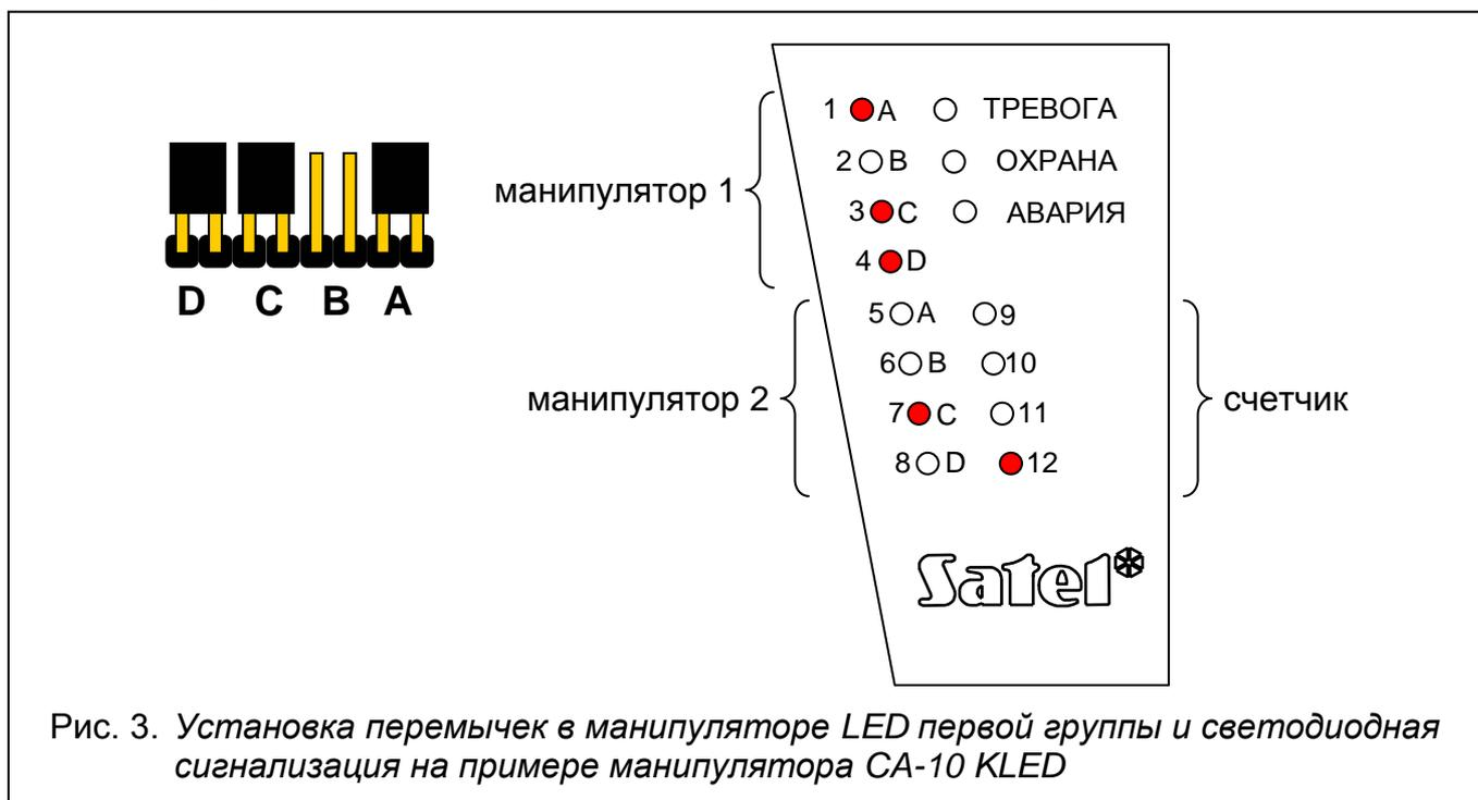
Рис. 3. Установка перемычек в манипуляторе LED первой группы и светодиодная сигнализация на примере манипулятора CA-10 KLED
