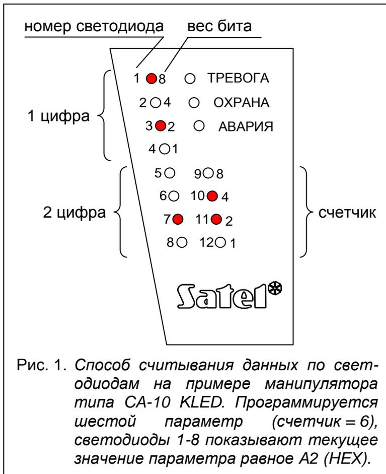
**Примечание:** В манипуляторах LED при программировании как десятичной, так и шестнадцатиричной функции, нажатие цифровой клавиши вызывает лишь выдачу на светодиоды соответствующей цифры (попеременно изменяется состояние светодиодов 1-4 и 5-8). Запоминание состояния параметра выдаваемого на светодиодах обуславливает нажатие клавиши [#].
