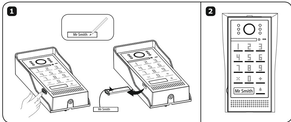
5. Umieśń kasetę zewnętrzną w daszku ochronnym. Pamiętaj by kamerę umieścić w taki sposób, by nie padały na nią bezpośrednio promienie słoneczne lub deszcz. Użyj klucza imbusowego i zamocuj kasetę za pomocą śrub.
