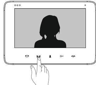
Um das Außentor zu öffnen, drücken Sie die Taste GATE STEUERUNG.
