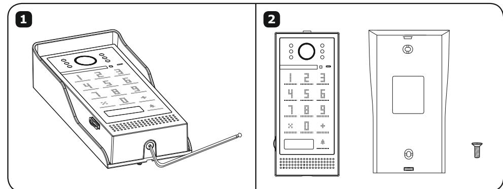
2. Befestigen Sie den Regenschutz mit Schrauben an der Wand.
