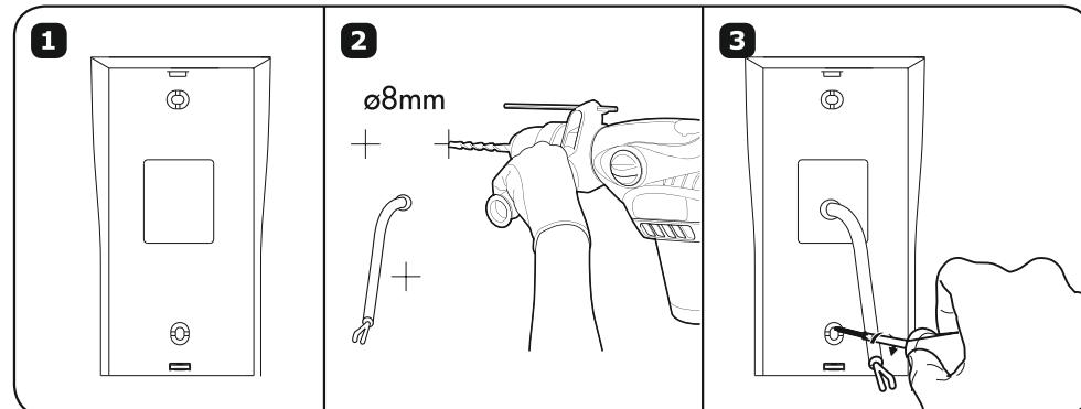
3. Podłącz przewody zgodnie ze schematem podłączenia (patrz Schemat podłączenia przewodów) i ustaw poziom głośności kasy zewnętrznej.
