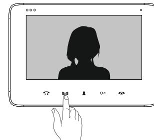
Aby otworzyć bramę zewnętrzną, naciśnij przycisk STEROWANIE BRAMA.
