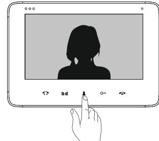
Um das Kamerabild in der Vorschau anzuzeigen, drücken Sie die ÜBERWACHUNG-Taste. Drücken Sie die gleiche Taste erneut, um in den Standby-Modus zurückzukehren.
