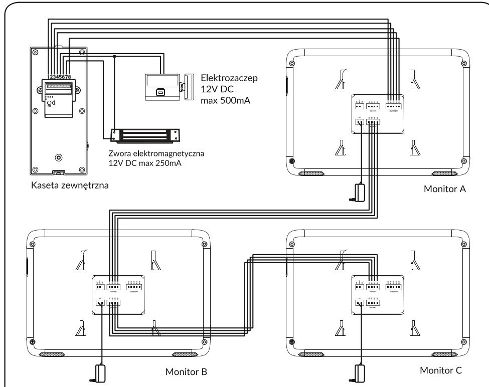
**Uwaga:** do urządzenia nie należy podłączać jednocześnie elektrozaczepu i zaczepu magnetycznego. Należy wybrać tylko jeden rodzaj zamknięcia.
