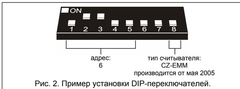
Рис. 2. Пример установки DIP-переключателей.
